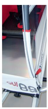
3. Führen Sie das Bremskabel unter dem Befestigungspilz des Bodenlatzes vorbei, über die schwarze Griffaussparung (Befestigung mit Klettband) hinauf zum Heck, zur roten Rändelmutter (unter der Gummilasche durch) und dann zum Stossbügel.
