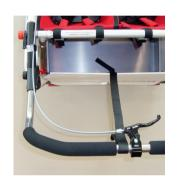
5. Nehmen Sie nun das Bremskabel (Gurtband am Griff) und führen Sie es dem Bild entsprechend zur Mitte des Stossbügels. Befestigen Sie nun den Bremshebel zwischen den beiden Griffpolstern. Kontrollieren Sie den festen Halt des Stossbügels.
