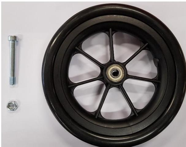
Zum Lösen der Schraube kann die Mutter mittels Ausparung in der Gabel gegengehalten werden.
