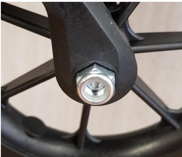
Die Schraube festziehen und auf der Gegenseite die Mutter in die Aussparung drücken.
