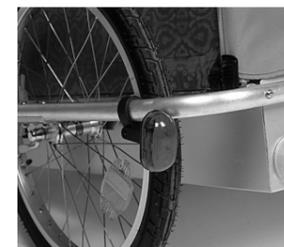
F1 Muttern anziehen und Spannhebel auf «Open» stellen.
