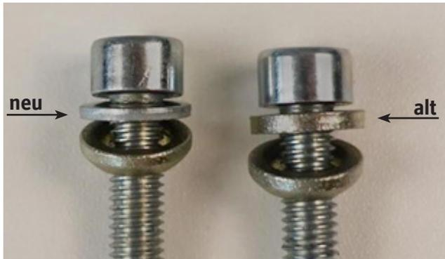
**Schritt 5:** Tauschen Sie bei den vier Schrauben die Unterlagsscheiben aus. Die mitgelieferten sind etwas dünner.
