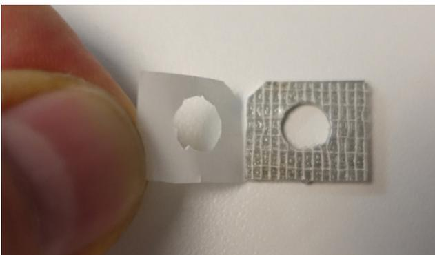
**Schritt 3:** Folie an Bremsattelunterlage entfernen.
