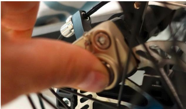
**Schritt 7:** Bremssattel auf die Bremsscheibe ausrichten und die Schrauben abwechselnd, gleichmässig festziehen. Überprüfen Sie während dem Festziehen, ob die Bremsscheibe parallel zu den Bremsbacken verläuft.
