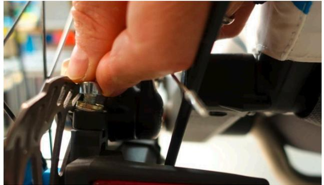
**Schritt 6:** Bremssattel wieder anbringen, Schrauben lose eindrehen.
