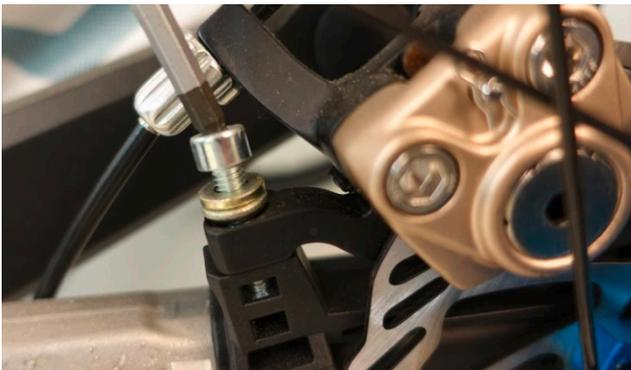
**Schritt 1:** Beide Schrauben am Bremsattel lösen. Dabei aufpassen, dass die Muttern nicht rausfallen.
