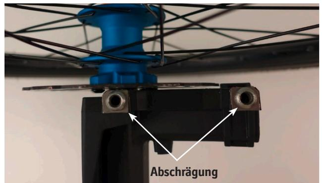
**Schritt 4:** Bremsattelunterlage vorne bündig und mit der Abschrägung übereinstimmend aufkleben.
