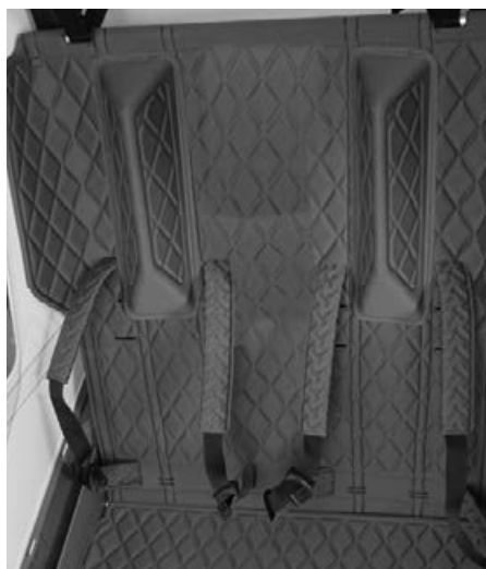
Beide inneren Gurtschnallen müssen vertauscht montiert werden
