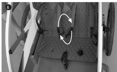
Beide inneren Gurtschnallen müssen vertauscht montiert werden
