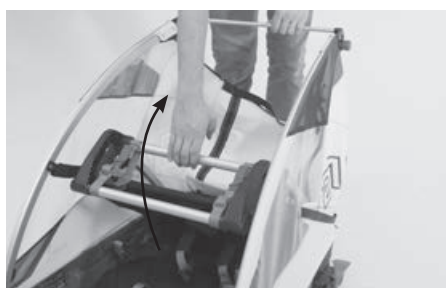
Frontaufbau mit einer Hand hochziehen und halten. Während der Frontaufbau hochgehalten bleibt, den Heckaufbau mit der anderen Hand aus der Wanne ziehen und gegenseitig einrasten.
