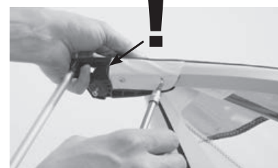
Achtung: Stofflasche soll bündig mit dem Rohrende sein! Jetzt kann alles miteinander verschraubt werden.
